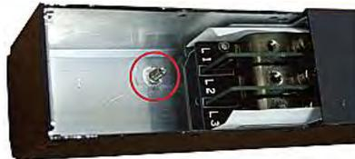
对于在线监视器，监视器背面的端子板是入口端子板，监视器正面的端子板是出口端子板。每个入口端子板有一个对应的出口端子板。
