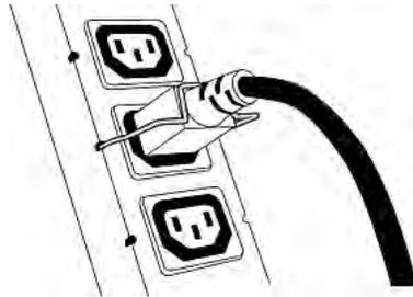
4. 重复上述步骤，在其他出口安装固定夹和电源线。
