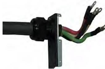
暂时用手拧紧电缆固定头螺母，确认电源线不打结或松动。如果用手拧紧螺母时电源线很松，切勿继续安装。在某些型号上，尤其是在线监视器，软电源线的直径对电缆固定头而言可能太小了。如果电源线直径较小，可能要在 Raritan 产品上垫一个密封圈，或者要求 Raritan 安装小内径电缆固定头。
